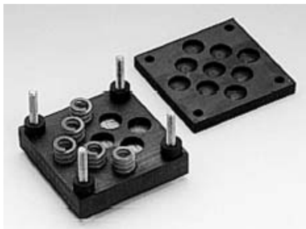
図4 セラミックばねを用いたろう付治具
