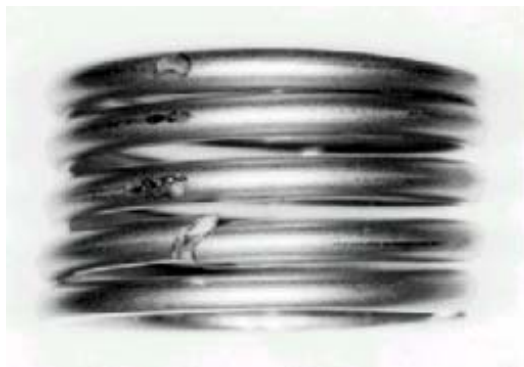
写真2-1 折損ばねの外観 SUS304-WPB 6.0mm
