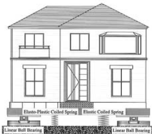
図1 コイルばねを鉛直設置した免震建物例
