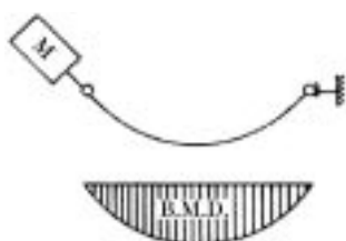
図2 ヘイ・ロバートソン式回転曲げ疲労試験機概略図
