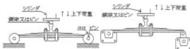
図6 ばねの支持および試験方法(コロ支持)
